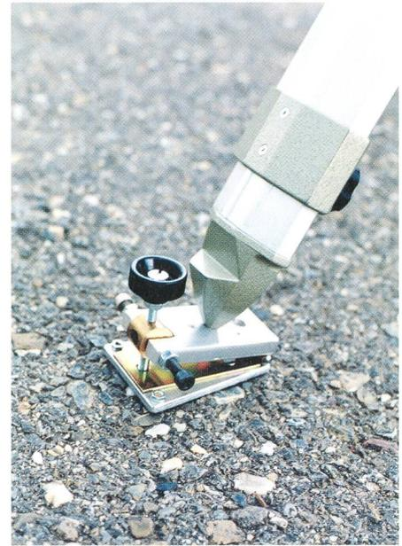
Fig. 2: L'équerre pour le réglage fin en altitude.
