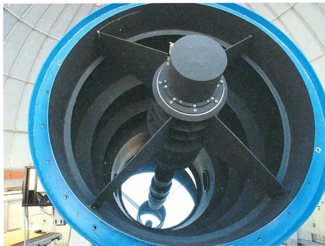
5. Le miroir de 1.2m du télescope Mercator.
