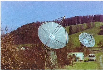
Fig. 2: Teleskope 5m-Spiegel links und 7m-Spiegel rechts.
