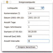
Fig. 3: Eingabemaske für die Simulationsparameter. Simuliert werden 9 Einzelstrahlen im Intervall von 10 Minuten (600 Sekunden), der erste um 6:20 Uhr UTC.
