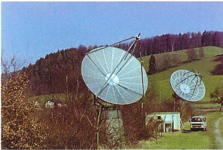
Fig. 2: Teleskope 5m-Spiegel links und 7m-Spiegel rechts.
