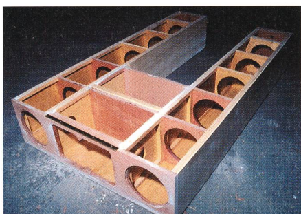
Das Sperrholzgehäuse im Bau. Die Zwischenrippen dienen gleichzeitig als Versteifung und zur Streulichtunterdrückung.
