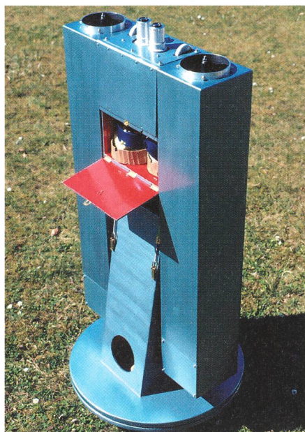
Feldstecher einmal anders: Das fertige 11.5 cm-Binokular.
