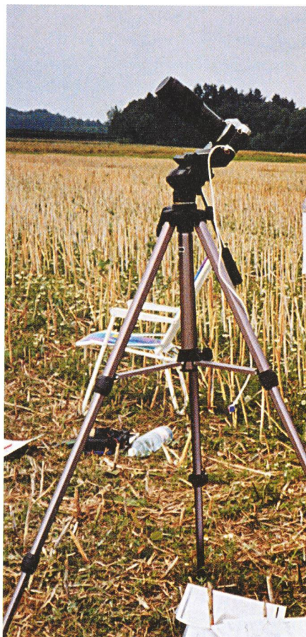
Fig. 11: Grenchenberg Schmidt-Kamera, Brennweite 1000mm, Spiegeldurchmesser 400mm, Öffnung 300mm. Lichtenknecker Flatfield Brennweite 500mm, F/D = 1:3,5.
