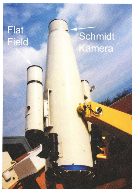
Fig. 11: Grenchenberg Schmidt-Kamera, Brennweite 1000mm, Spiegeldurchmesser 400mm, Öffnung 300mm. Lichtenknecker Flatfield Brennweite 500mm, F/D = 1:3,5.
