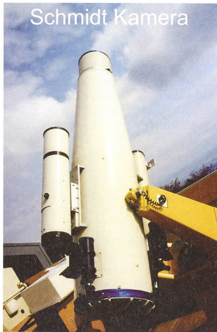
Fig. 10: Schmidt-Kamera, Brennweite 1000mm, Spieldurchmesser 400mm, Öffnung 300mm.
