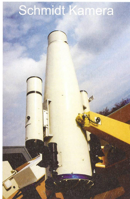
Fig. 10: Schmidt-Kamera, Brennweite 1000mm, Spieldurchmesser 400mm, Öffnung 300mm.
