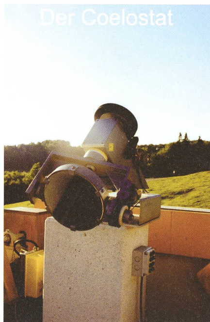
Fig. 4: Coelostat zur Sonnenbeobachtung.
