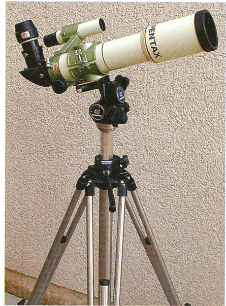
Fig. 1: Das Manfrotto-Stativ Triman 028 mit dem Junior Getriebeigekopf 410 bildet eine leichte und dennoch sehr stabile azimutale Astro-Montierung für kleine Fernrohre.
