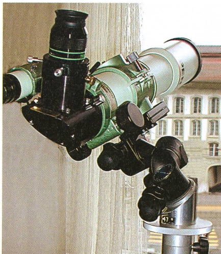
Fig. 2: Wird der Getriebe-Neigekopf zusätzlich auf eine geeignete Neigevorrichtung gesetzt, entsteht daraus eine robuste parallaktische Montierung mit manueller Nachführung. Im Bild ein eigens gefräster Adapterkopf mit 47° Neigung. (Bild: MICHEL FIGI)
