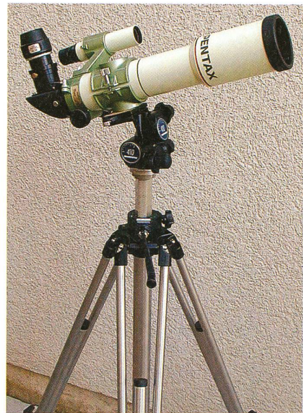
Fig. 1: Das Manfrotto-Stativ Triman 028 mit dem Junior Getriebe-Neigekopf 410 bildet eine leichte und dennoch sehr stabile azimutale Astro-Montierung für kleine Fernrohre.
