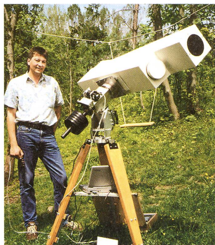
Der Autor mit einigen seiner selbstgebauten Geräte: Yolo-Schiefspiegler, Öffnung 150mm, F 1:12, parallaktische Montierung und Holzstativ
