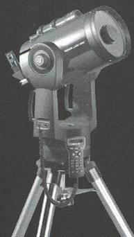
203mm (8") Schmidt-Cassegrain mit einer Brennweite von 2000mm (f/10), AutoStar Handbox mit 30'223 Objekten aus den gängigen Sternenkatalogen, GoTo-Funktion mit 9 Geschwindigkeiten, kann mit einem PC gesteuert werden (Verbindungskabel und Software als Option).
