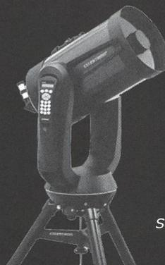
279mm (11") Schmidt-Cassegrain mit einer Brennweite von 2800mm (f/10), GoTo-Computer mit über 50'000 Objekten. Automatisches Einrichten dank integriertem GPS und elektronischem Kompass. Tubus kompatibel für Fastar (f/2 CCD), Anschluss für AutoGuider, PEC-Funktion, Gewicht Teleskop / Stativ: 29.5kg / 12kg
