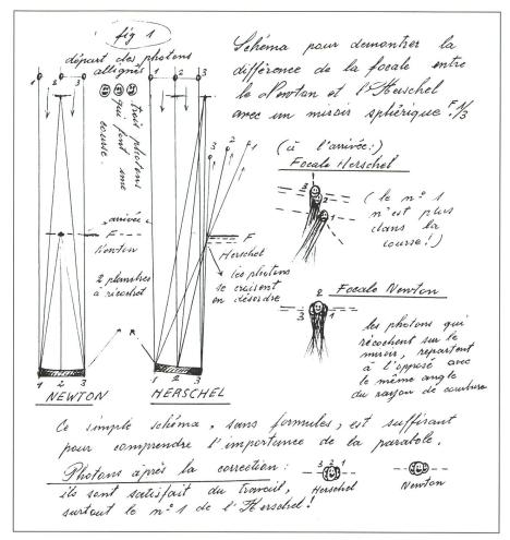
Dans toute la littérature et méthodes concernant la construction d'un télescope amateur, Newton ou Cassegrain, les miroirs sont symétriques. Par contre, pour un Yolo ou Herschel, les miroirs sont asymétriques.
