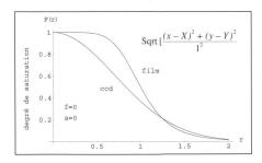
cela, on construit une fonction mathématique que l'on vient ajuster sur les valeurs observées pour chaque pixel dans le voisinage de l'objet à mesurer. Cet ajustement se fait en modifiant les paramètres de la fonction, tels que coordonnées du photocentre, valeurs du fond et de l'amplitude de la tache ainsi que sa largeur. En imagerie cécédé, on utilise volontiers des gaussiennes
