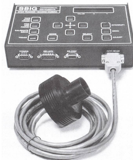
La caméra ST4 de SBIG (Santa Barbara Instrument Group) a une matrice de 165 x 192 pixels. Elle est refroidie par effet Peltier. Elle est ici accompagnée de sa palette de commande.
