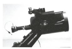
Télescope C8 muni d'un système projectif. Le boîtier est muni d'un déclencheur souple. Devant le télé-convertisseur on distingue le compteur digital de focalisation. Sur le télescope, le système de visée Telrad et derrière la lunette de visée 8x50.
