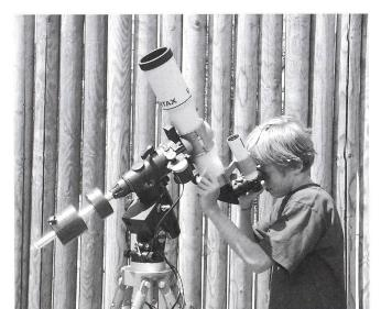
1<sup>1</sup>/<sub>4</sub>"-Adaptionshülse und Okular Pentax XL 21mm (65° Gesichtsfeld). Pentax Rohrschelle BH-75, Celestron Great Polaris Montierung (Deutsche Montierung) mit Polsucher und Gegengewichten. Elektronische Nachführmotoreinheit in Deklination und Rektaszension mit Handsteuerung, Hartholzstativ G3 mit Dreibein und zusätzlichen Beinschnallen für noch bessere Stabilität, Dreipunktfixation und Kegelspitzen!
