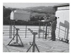
Fig. 2: W. Winiger am Coelostat mit 10cm Spiegeln und abgefahrenem Gehäuse mit Blick nach Westen (Haus Gust). Das Sonnenbild von ca. 40cm Durchmesser wird durch ein liegendes Fernrohr von 160cm Brennweite und einem Spezialokular an der gegenüberliegenden Innenwand erzeugt. Gut sichtbar sind auch Details der in der Höhe verstellbaren Montierungen für 4 SC's. Man beachte auch die höchst reizvolle Landschaft.
