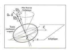
Un élément de matière  $\Delta m = \rho \Delta V$  de la Terre aura un moment cinétique  $\Delta \vec{B} = \rho \Delta V \vec{r} \wedge \vec{v} = \rho \Delta V r^2 \omega \sin \vartheta \vec{k}$   $\Delta \vec{B} = \Delta m (\vec{r} \wedge \vec{r} + \vec{r} \wedge \vec{r}) =$
