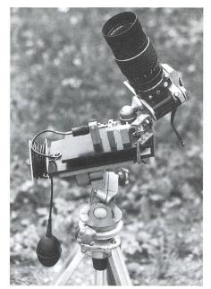
Fig. 2. Mit Luftpumpenbetrieb erschütterungsfreies Nachführen eines 200mm Teleobjektivs.
