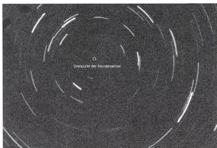
Abb. 2: Aufnahme mit 5 min Bel.-Zeit, während der die Stundenachse um ca. 20 Grad gedreht wurde. Aufnahmeinstrument und Kamera wie oben.
