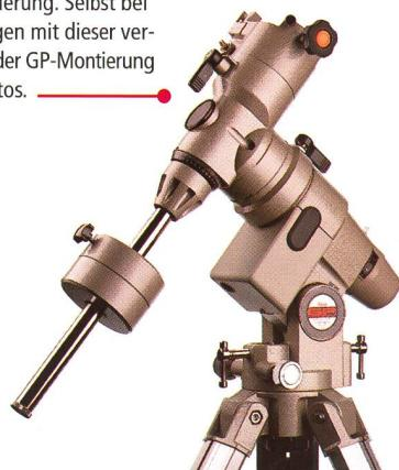
Komplett und hochwertig – Die Grundausstattungen der Vixen GP-Teleskope enthalten: Optik mit Tubus, Great Polaris-Montierung, Aluminiumstativ höhenverstellbar von 93cm bis 150cm (62 bis 90cm bei ED/FL 80/90S und bei den Reflektoren; 77cm bis 110cm bei den DX-Modellen), Polsucherfernrohr mit Beleuchtung, Sicherfernrohr 6x30, Zenitprisma Ø 1 1/4", Okular 20mm LV Ø 1 1/4", Behälter für Zubehör und Werkzeug.
