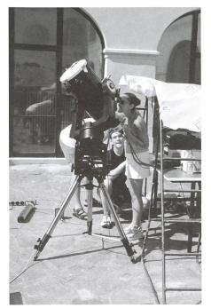
Fig. 10. Ein 10" LX 200 von Meade mit H alpha Filter und CCD-Kamera (ESA-Material).
