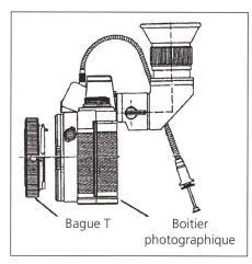
La figure ci-dessus montre un boîtier muni d'une telle loupe, d'un déclencheur souple et d'une bague T permettant de fixer l'appareil sur un télescope (il existe de telles bagues pour chaque marque de boîtier).
