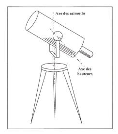
siette soit parfaitement horizontale. L'avènement récent de microcalculateurs à prix raisonnables a cependant permis la mise sur le marché de montures azimutales pilotées par des moteurs à quartz de grande précision, supprimant du même coup les inconvénients précités. Cependant, les dérotateurs de champ sont chers et rarement disponibles.
