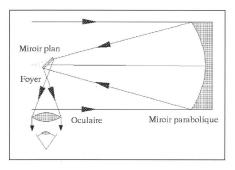
D'autre part, la position de l'oculaire, nécessite, en cours d'observation, des contorsions sinon disgracieuses, du moins inconfortables. Enfin pour l'astrophotographie, une telle disposition n'est guère pratique, puisqu'en plus du balourd créé par l'appareil photo, la poursuite à l'aide d'une étoile-guide est malaisée. Mais il s'agit néanmoins d'un bon appareil d'observation, relativement peu coûteux.
