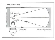
Le Schmidt-Cassegrain: Il s'agit de l'appareil actuellement le plus répandu. Il est doté d'un miroir principal sphérique (donc plus facile à construire) et d'un petit miroir secondaire divergent, placé juste avant le foyer du miroir principal. Une lame de Schmidt assure la correction de l'aberration de sphéricité tout en fermant le tube, protégeant par
