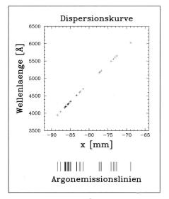
werden Residuen genannt. Die Berechnung einer Näherungsfunktion, in unserem Falle die Bestimmung der Koeffizienten (a,b,c,...) eines Polynoms  $\lambda(x)=a+bx+cx^2+dx^3+...$ , wird durch ein Computerprogramm vorgenommen.
