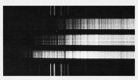
Fig. 12: K-Sterne. Gelb-rote Sterne von geringer Temperatur (5000°); schwache Wasserstoffund deutliche Metalllinien.
