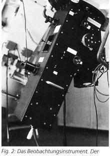
Spektrograph ist am 60 cm Cassegrain-Teleskop montiert. Seine Gesamtlänge beträgt etwa 1 m.
