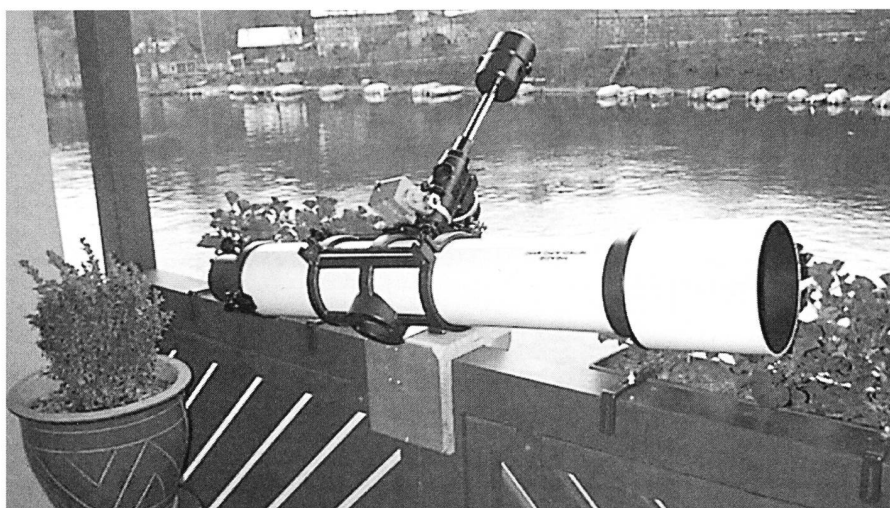
Fig. 2. Das Fernrohr wird in unterer Lage in die Schellen gelegt und mit Zubehör bestückt. Loses Gerät würde somit nicht in den Rhein fallen.
