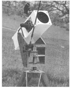
Figure 2: Le télescope Houghton 130/150/50û installé pour l'observation visuelle: un porte-oculaire est monté sur la platine photographique à la place du boîtier photo.
