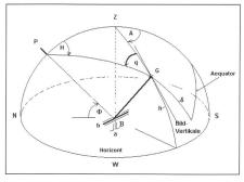
Bei der Äquatorial-Montierung ist a nicht auf den Zenit, sondern auf den Himmelspol P gerichtet, a entspricht der Stundenachse, b (das ebenfalls senkrecht zu a steht), der Deklinationsachse.
