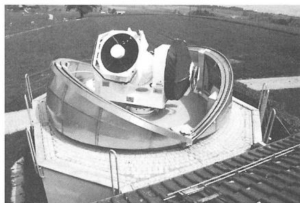
ZIMLAT auf seiner azimutalen Gabelmontierung. In seiner Öffnung der Sekundärspiegel und rechts, am Ende der Horizontalachse, die Plattform mit den Kameras (schwarze Trommel).
