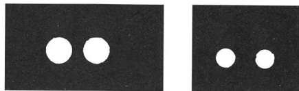
Figur 5a: Beugungsbilder eines Doppelsterns, links durch ein kleines, rechts durch ein grosses Instrument bei gleicher Vergrösserung gesehen.
