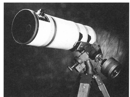
Abb. 1: Der etwa 15 Jahre alte, von POPP gebaute 300mm f/4 Newton mit dem originalen weißen Kunstlederbezug auf einer AOK WAM 30CC Montierung. Etwas schlecht sichtbar ist die alte, einarmige Fangspiegelhalterung.
