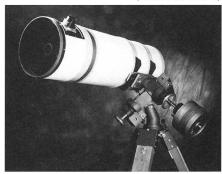
die Innenseite des Tubus war mattschwarz gestrichen und wies keine Blendenringe auf, sondern nur zwei Tragringe, welche aber in gewisser Weise auch wie Blenden funktionieren. Der vorderste Teil des Tubus kann samt Okularauszug und Fangspiegelhalterung auf sechs kleinen Kugellagern um die Längsachse gedreht werden. Dies ermöglicht zwar in jeder Teleskoplage einen bequemen Einblick, führt jedoch zu Kollimationsproblemen, welche später noch kurz beschrieben werden.
