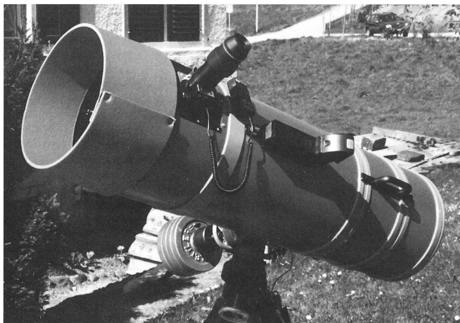
Abb. 2: Fast dasselbe Teleskop in seinem neuem blau/grünen Outfit und mit einer von DANY CARDOEN veredelten Optik. Man beachte die Taukappe aus einer Camping-Schaumstoffmatte und den JMI NGF-1 Okularauszug.
