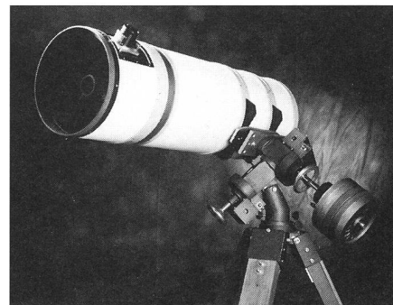
Abb. 1: Der etwa 15 Jahre alte, von POPP gebaute 300mm f/4 Newton mit dem originalen weissen Kunstlederbezug auf einer AOK WAM 30CC Montierung. Etwas schlecht sichtbar ist die alte, einarmige Fangspiegelhalterung.
