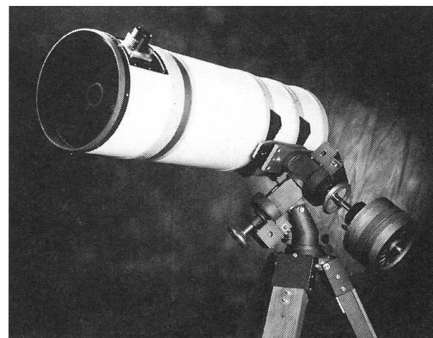
Abb. 1: Der etwa 15 Jahre alte, von POPP gebaute 300mm f/4 Newton mit dem originalen weißen Kunstlederbezug auf einer AOK WAM 30CC Montierung. Etwas schlecht sichtbar ist die alte, einarmige Fangspiegelhalterung.
