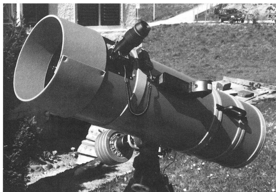
Abhilfe schafft die Montage von Blendenringen, die so positioniert werden, daß weder das einfallende noch das vom Hauptspiegel reflektierte Licht über die Tubusinnenwände ins Okular gelangen kann.
