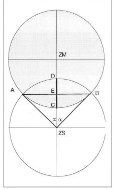
Bild 6: Berechnung des unverfinsterten Flächenanteils der Sonne.
