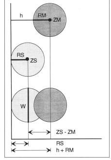
Bild 5: Berechnung der Distanz von Sonnenzentrum zu Mondzentrum in Grad Legende: ZS = Zentrum Sonne; ZM = Zentrum Mond; h = unbedeckter Anteil der Sonnenscheibe; W = Durchmesser Sonne; RS = Radius Sonne; RM = Radius Mond; h/W = Verhältnis ungedeckter Anteil Sonnendurchmesser zu Sonnendurchmesser
