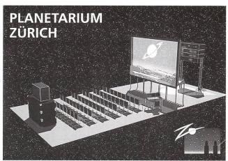
Bild 1: 3-D Ansicht des Planetariums. Der Hauptprojektor, ganz rechts im Bild, steht hinter der matt-durchsichtigen Kunstoffleinwand. Das Horizontbild dagegen wird vom 3-fach-Panoramaprojektor über das Publikum hinweg auf eine undurchsichtige, der Horizontlinie angepasste Silhouette projiziert. (Illustration Lukas Zeller)
