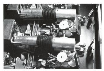
Bild 3: 2 der 5 Planetenprojektoren vom Typ «Simpel». Man erkennt links das Lampenhaus, den Revolver mit den verschiedenen Bildern und die Tubusrohre, in denen vorne ein achromatisches Objektiv eingebaut ist. Deutlich zu sehen sind daneben die Ablenkeinheiten, Planspiegel, welche mit Servomotoren über Zahnräder in 2 Achsen äusserst präzise bewegt werden können. (Bild Planetarium Zürich)
