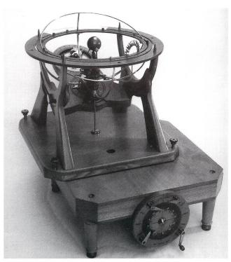
Abb. 7. Ein Hebel führt das Planetarium auf einer Kreisbahn um das Tischzentrum herum, während drei Zahnräder die parallele Ausrichtung beim Jahreslauf oder die Drehung bei der Präzession besorgen. Dabei läuft die Ekliptik an der stets über dem Tischzentrum stehenden Sonne vorbei.
