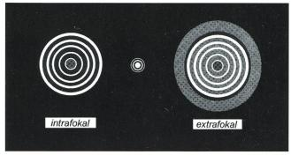
Abb.5: Mit Hilfe des Computers schematisch gezeichnet die intra- und extrabokalen Beugungsbilder von 75 und 105 SDHF bei 100- bzw. 140-facher Vergrösserung.
