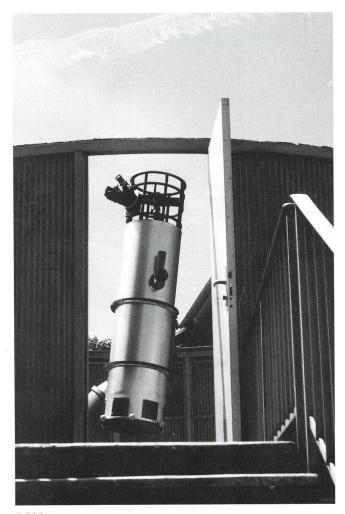
Anblick des 16-Zöllers durch die geöffnete Tür des Kuppelraums: der vordere Teil des Tubus wird auch von einem Stahlmantel geschlossen.
