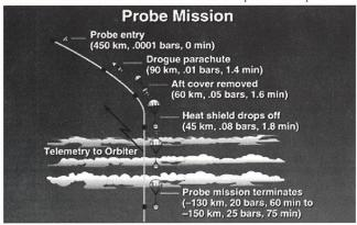
speichert wurden. Die hohen Drücke und Temperaturen waren vermutlich die Ursache dafür, dass die Kommunikation zwischen Sonde und Mutterschiff ca. 57 Minuten nach Beginn des Abstiegs zusammenbrach.
