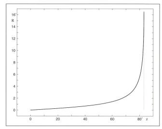
Figur 2: Refraktion in der Venusatmosphäre als Funktion der scheinbaren Zenitdistanz. Bei einer Zenitdistanz von rund 83° wird die Refraktion unendlich. Das bedeutet, dass der scheinbare Horizont sich 7° über dem mathematischen befindet.
