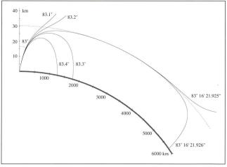
Figur 3: Wege von Lichtstrahlen, welche bei einem Beobachter aus unterschiedlichen Zenitdistanzen eintreffen. Strahlen, welche aus z < 83.2° kommen, stammen von ausserhalb der Atmosphäre während solche aus z > 83.3° von einem Punkt am Boden herkommen. Die x-Achse zeigt die Krümmung der Venusoberfläche, während die Höhe 40mal überhöht ist. Die angegebenen Zahlenwerte stimmen nur für eine Wellenlänge und für eine durchsichtige und turbulenzfreie Atmosphäre.
