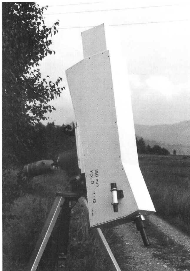
Bild 1.: Yolo Schiefspiegler, 150 mm Öffnung f/12 , in Holztubus auf Badener-Montierung.
