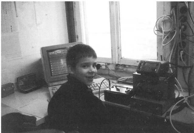
Bild 3: Der 'Junior-Autor' bei der Überwachung der Empfangsanlage bestehend aus Kommunikationsempfänger, ZF-Eichleitung, Quadratischer Demodulator und Verstärker sowie Analog-Multimeter. Nicht sichtbar der PC zur Messdatenerfassung via A/D-Wandler. Im Hintergrund der Steuer-PC zur automatischen Nachführung des Spiegels in Azimut und Elevation.
