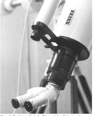
Figur 3: Das hintere Ende des Tubus mit dem Fokussiertubus sowie dem Zeiss-Binokularansatz und dem verstellbaren Sucher.
