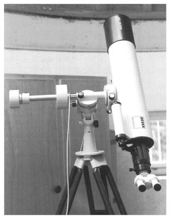
Figur 2: Der Zeiss-Refraktor APQ 130/1000 auf der Montierung Ib.
