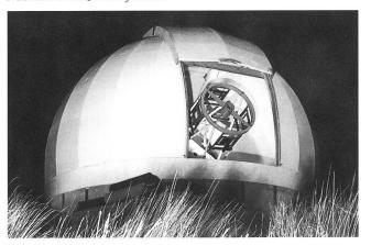
Das 106cm-Teleskop in seiner Kuppel von Westen gesehen. Hinter der Spiegelzelle erkennt man die 12 astatischen Ausgleichshebel.
