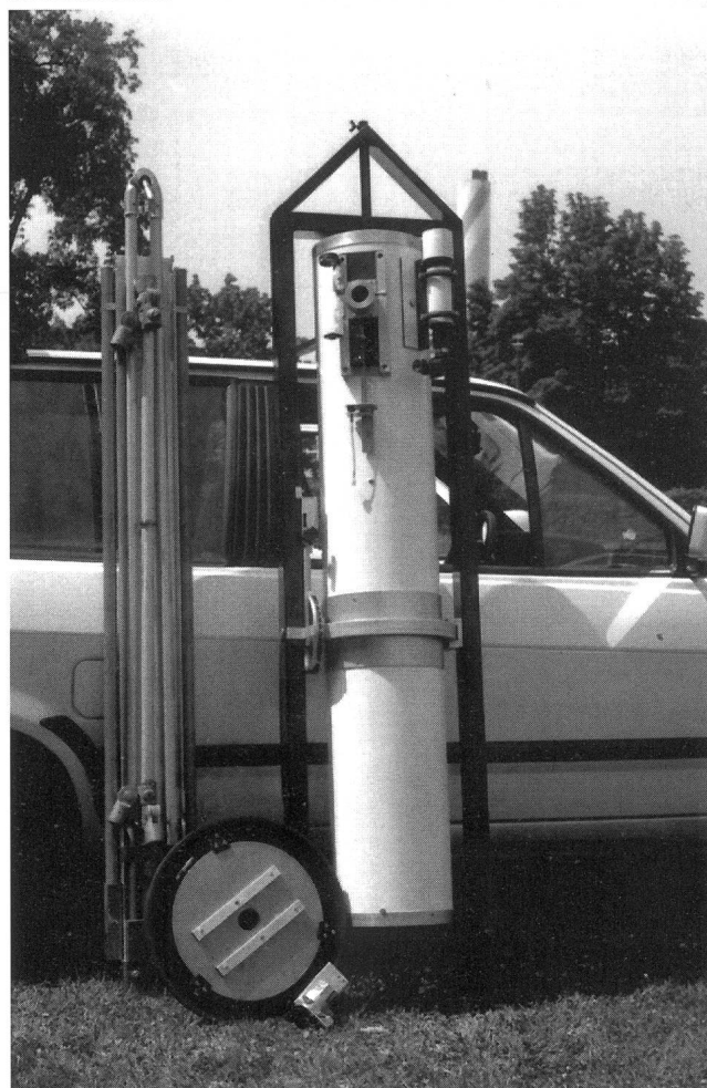
Bild 3: Demontierte Tetraedermontierung. Ersichtlich sind die im U-Profil zum Transport versorgten Rohrstangen, Rahmen mit Rohr und Antriebseinheit.
