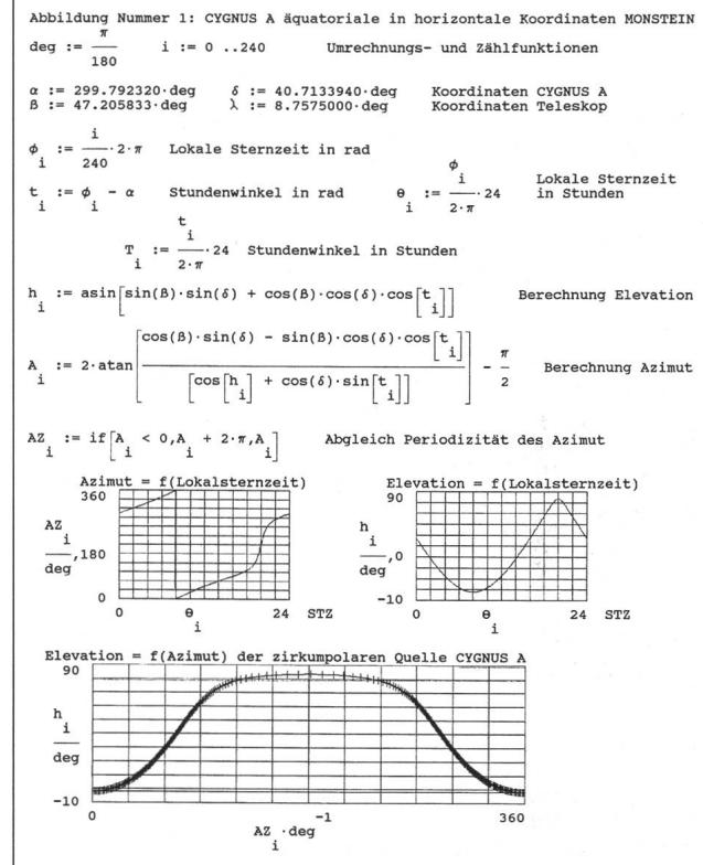
Koordinatentransformation für Cygnus A von äquatorial in horizontal für den Standort des Autors in Freienbach. Für Azimutscans werden die Zeiten geplant, wo die Elevation möglichst wenig ändert. Für Elevationscans werden die Zeiten geplant, wo das Azimut möglichst keine oder zumindest geringe Änderung zeigt.
