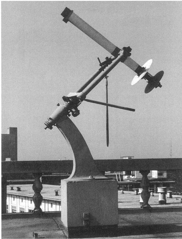
Abb. 5: Das Fraunhofersche Fernrohr (1855), d=8\text{cm} , f=110\text{cm} , auf der Dachterrasse, zur Bestimmung der Zürcher Sonnenflecken-Relativzahl.
