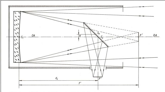
Abb. 2; Newton-Spiegelsystem mit Strahlengang und Fangspiegel-Anordnung Um nicht unerwünschte Daumenabdrücke auf der Spiegelfläche zu erhalten, legt man ein Papiertaschentuch unter:
