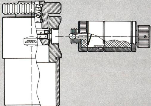
Dieses neu entwickelte, mit lasergeätztem Meßplättchen versehene orthoskopische Okular mit regelbarer Beleuchtung erschließt dem Astroamateuer neue Arbeitsmöglichkeiten. Es läßt sich u. a. für folgende Aufgaben einsetzen:
