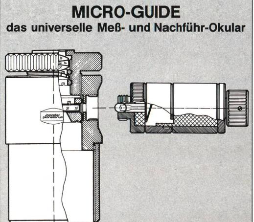
Dieses neu entwickelte, mit lasergeätztem Meßplättchen versehene orthoskopische Okular mit regelbarer Beleuchtung erschließt dem Astroamateuer neue Arbeitsmöglichkeiten. Es läßt sich u. a. für folgende Aufgaben einsetzen:
