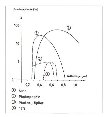
lineares (!) Mass für die Helligkeit aufzufassen. Beim CCD hingegen kann man die Intensität direkt und vor allem als lineares Mass für die Helligkeit heranziehen.
