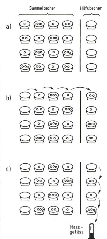
Messzylinder gegossen, und der Inhalt der anderen Becher wandert auch wiederum einen Becher weiter gegen den Rand zum messzylinder (c). Die Messung des Inhaltes des eben gemessenen Regenwassers wird aufgeschrieben, und der Schritt (c) wird wiederholt, bis die gesamte Reihe gemessen ist. Danach wird wie in (b) wieder eine Zeile ausgelesen und mit (c) gemessen. So wird fortgefahren, bis alle Sammelbecher gemessen sind. Nun ist unser Feld wieder für die nächste Messung bereit.
